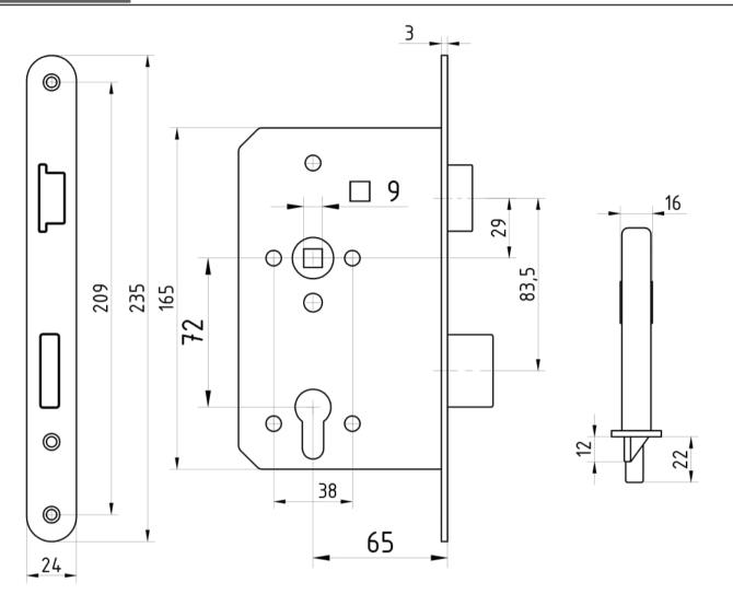
serrure encastrée entraxe : 72 mm axe du cylindre : 65 mm
