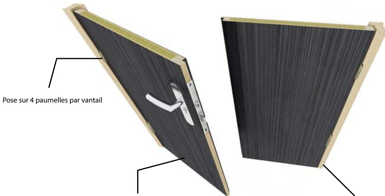
Vantail composé d'un cadre en bois en hêtre supportant une âme en lin prise entre deux panneaux médium bois. La finition est pré-peinte ou stratifiée. Epaisseur 40 mm (coupe feu 1/2h) ou 50 mm (Coupe feu 1h)
